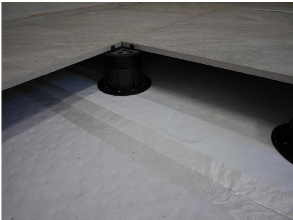
Abbildung B.4. Prüfaufbau während der Montage: Keramikfliesen auf Stelzlagern und Regupol® sound and drain 22.
