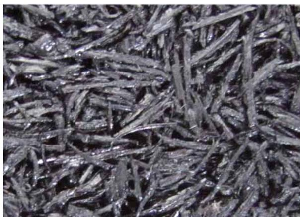
Die Materialstruktur der **Regupol® Elastikplatte RG 520** ist deutlich offener.
