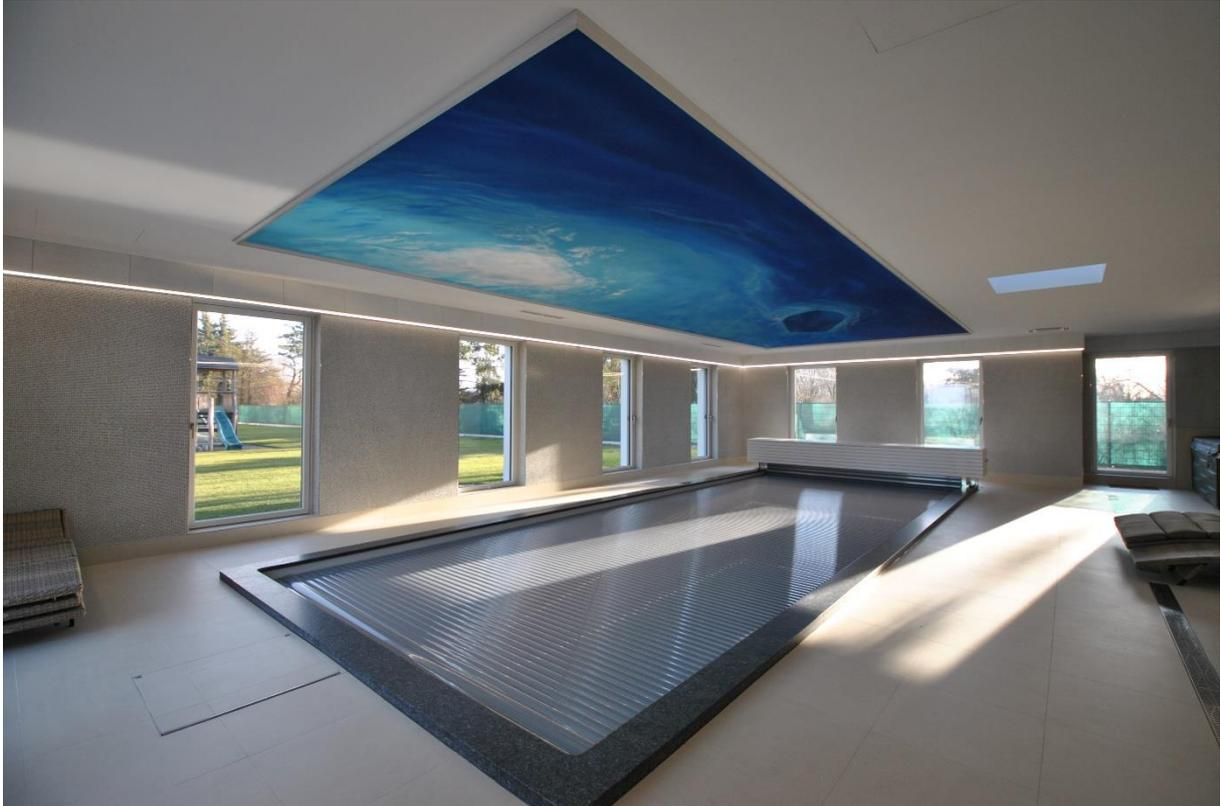
Die Fläche des Schwimmbades sind ca. 109 m<sup>2</sup>. Der Ringabsorber wurde vertikal am oberen Rand der Wände zur Decke hin montiert. Die Fläche des Ringabsorbers sind ca. 13,17 m<sup>2</sup>.
